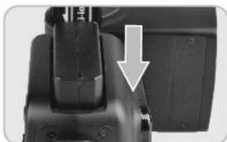
Чтобы загрузить аккумуляторную батарею, отодвиньте крышку отсека батареи и откройте его.
