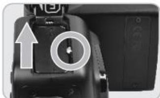
Чтобы достать батарею, отодвиньте белую ручку, и батарея вытолкнется. Затем закройте отсек.
